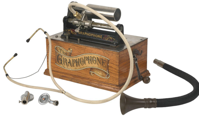
Fonógrafo-Graphophone tipo A fabricado por Columbia Phonograph Co. en Washington D.C., 1896, y vendido por Hugens y Acosta en Madrid. BNE, CE2716.
