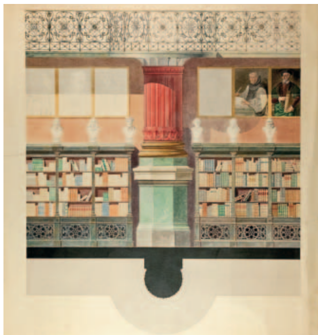
Detalle del pedestal y el arranque de una de las columnas adosadas del salón central de lectura de la Biblioteca Nacional, según proyecto de Antonio Ruiz de Salces. Madrid, AMAN. C-10-h Carp35.
