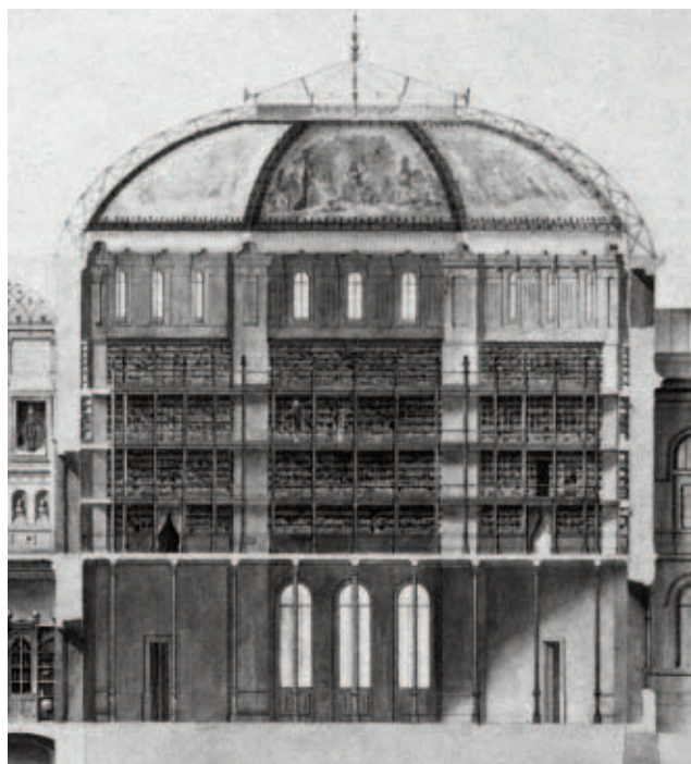
Sección del salón central de lectura, según el proyecto de Francisco Jareño en 1865. Madrid, BNE. 17/22/53, detalle.
