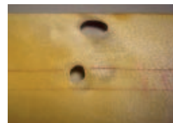
MPCANT/83 Agujeros en el pergamino. Defecto de la fabricación
